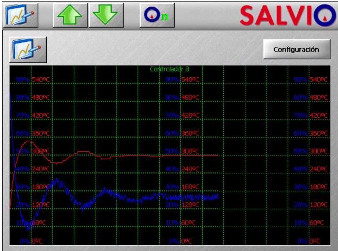
Cada división temporal representa 200 segundos de tiempo. En la zona gráfica se indica en color rojo la escala y la representación de la temperatura y en color azul la escala y representación del porcentaje de salida. Se puede configurar el rango de temperaturas a mostrar y que zona se representa pulsando el botón de configuración.
